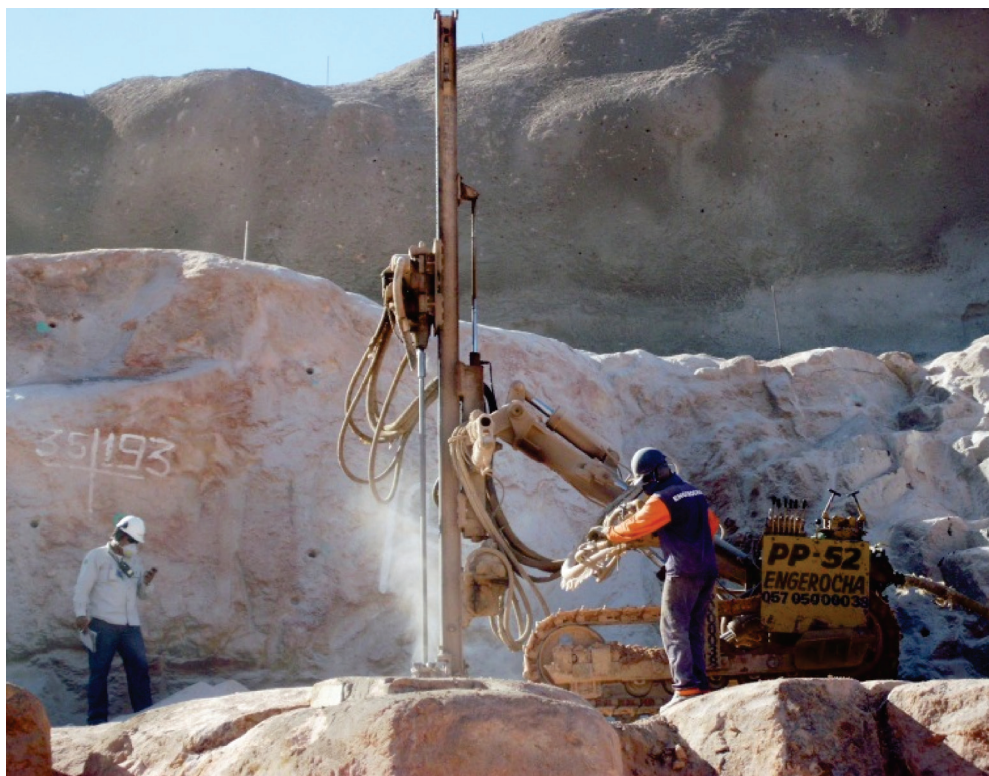
Figura 5 – Foto ilustrativa de sondagem a rotopercussão com perfuratriz a ar comprimido
