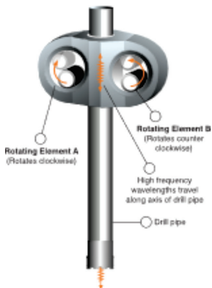
Figura 2 – Ilustração do funcionamento do cabeçote sônico, com os pesos desbalanceados e girando em sentidos opostos.
