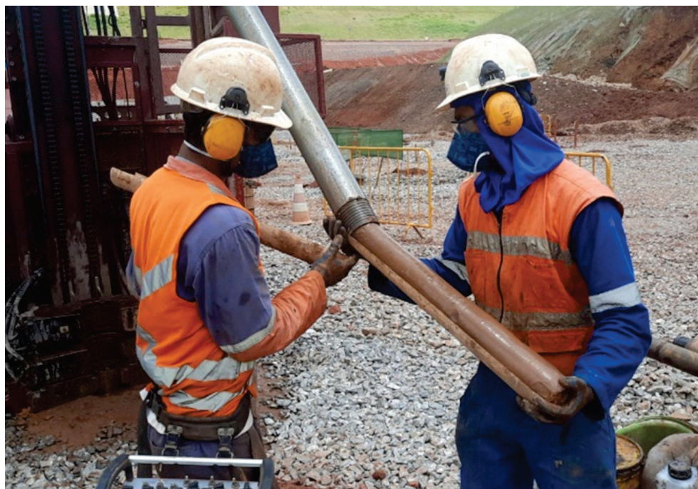
Figura 3 – Retirada de amostra de solo do barrilete sônico. A amostra sai por meio da vibração do barrilete pelo operador, até uma calha, e após é acondicionada na forma adequada.
