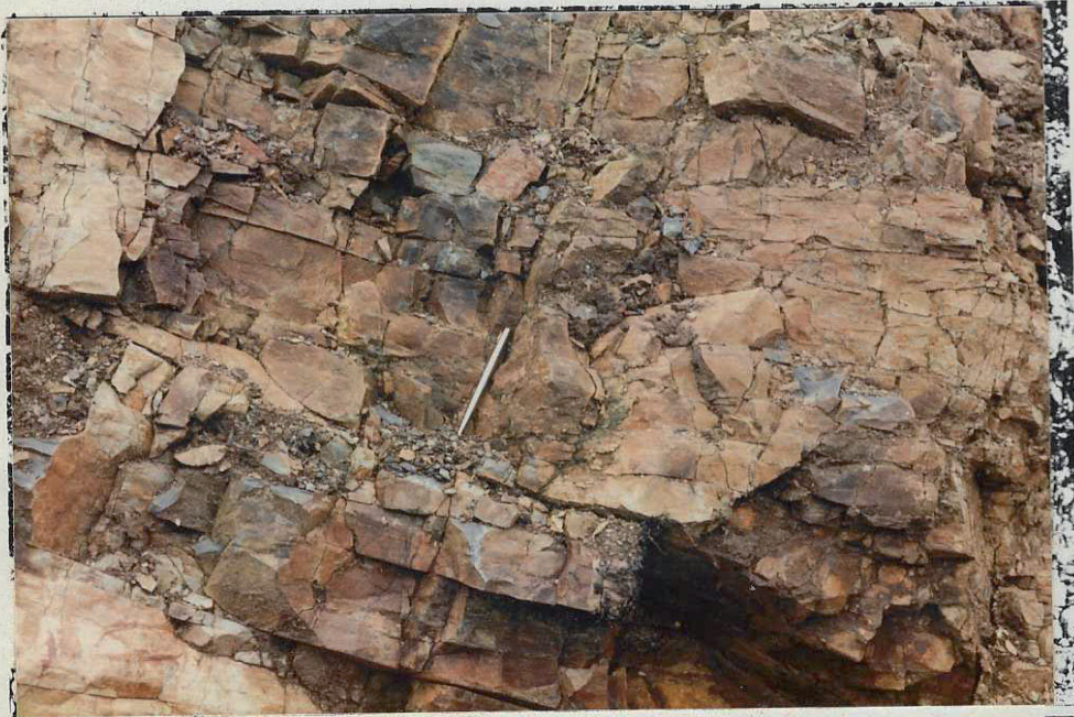
Foto 3 - Andesita (20 a 10 fracturas/m → F3; praticamente sana → A1 : clase III)
