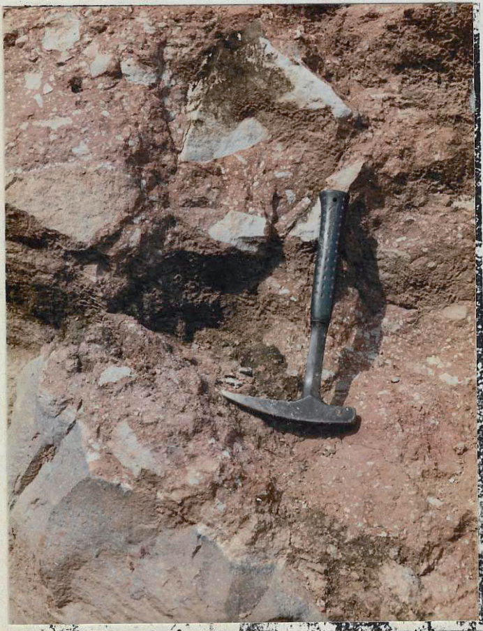
Foto 6 - Brecha tobácea (trechos friables/C3 y trechos de resistencia intermedia/C2, seca/H1, no se observa la presencia de fracturas: clase IV*)
