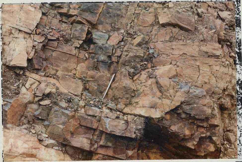
Foto 3 - Andesita (20 a 10 fracturas/m → F3; praticamente sana → A1 : classe III)
