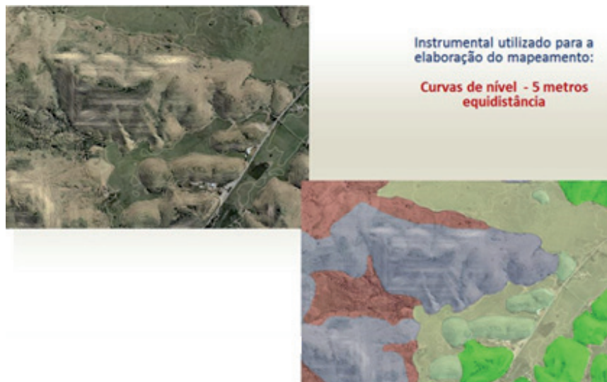
Figura 4 - Arquivo vetorial de curvas de nível com equidistância de 5 metros. No plano acima, associado com o raster da imagem. No plano abaixo, associado com a interpretação de padrões de relevo.
