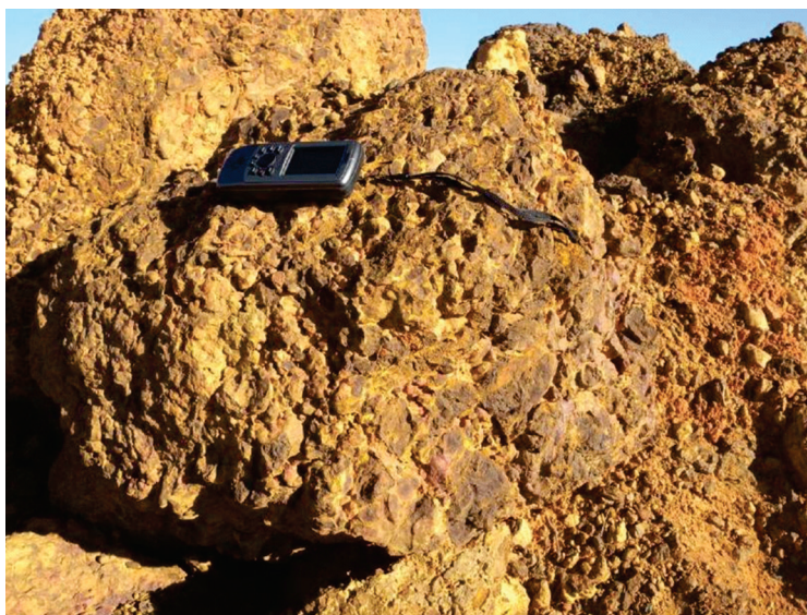
Figura 2.4 - Formação de crostas porosas, de resistência mecânica desuniforme, em sedimentos e solos superficiais.
